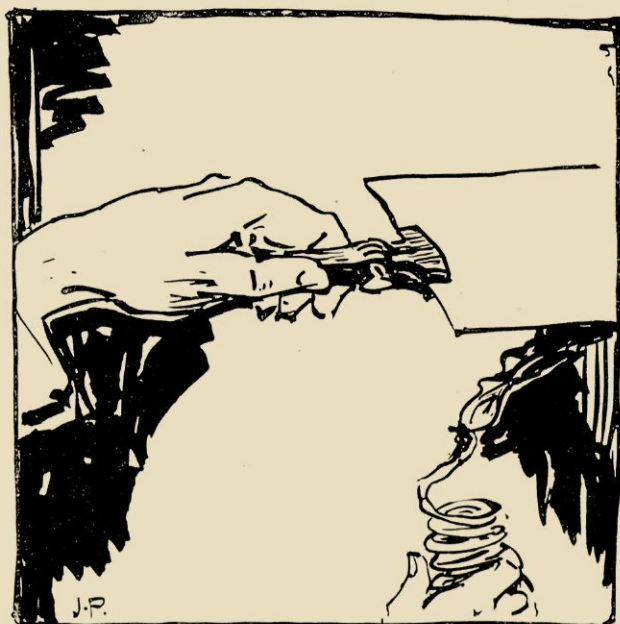
AFB. 2. HET WALMEN VAN DE GEVERNISTE PLAAT, WAARBIJ DEZE MET EEN TANG WORDT VASTGEHOUDEN.
